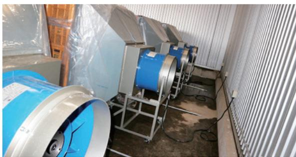
種芋蒸熱処理機による蒸熱消毒状況
