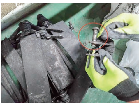
損耗が進んでいるチェーンのピン部分
