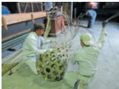
写真 24 外胴 4 本目編み込み
