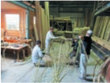
写真 12 ヘギを同じ向きで集める
