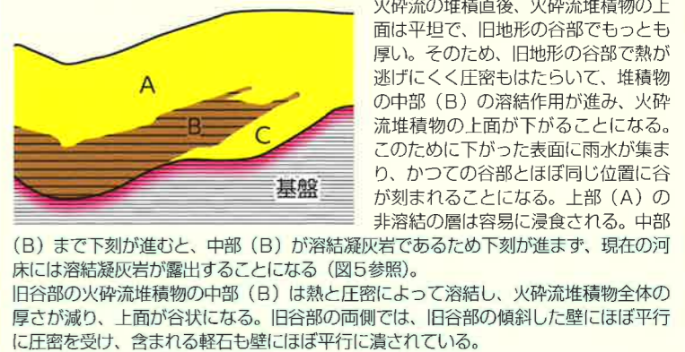
図4 少しずつ洞穴が形成されていく (洞穴を横から見た図)
