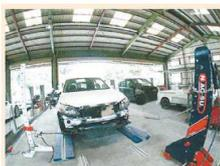
钣金部門の充実を図るためフレーム修正機を導入。より精度の高い仕上がりが可能になった。
