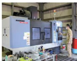
発泡スチロールの金型を作る精密機械、入力されたデータを元に自動で動く。
